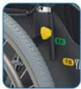
レバーによる 手動と電動の切り替え
